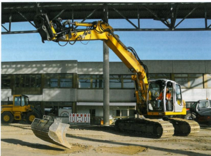
**Falsch verwendet** können Schnellwechsel-Einrichtungen für Baumaschinen tödliche Gefahren bergen. (Foto: BG Bau)
